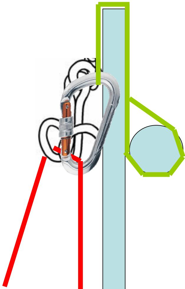
Um eine Redundanz bei der Umlenkung zu schaffen, nimm eine Bandschlinge und hänge diese mittels Ankerstich in das oberste Querrohr (Wo auch die Wand befestigt ist).
